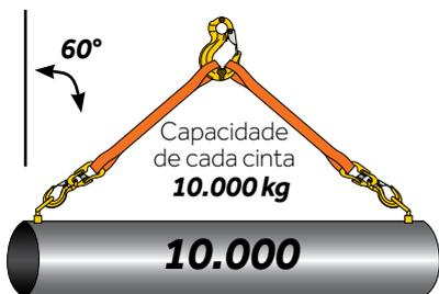
Com um ângulo de 60°, necessitamos de cintas com a mesma capacidade que o peso da carga (10.000 kg).
