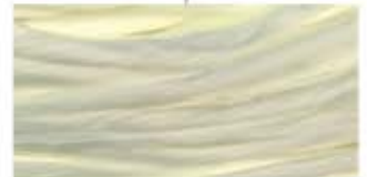
Núcleo em Dyneema® SK78 (HMPE)
