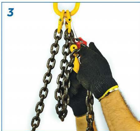
Passo 3: Introduza o elo dobrado no gancho encurtador.
