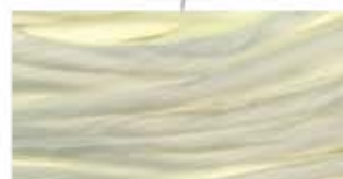
Núcleo em Dyneema® SK78 (HMPE)
