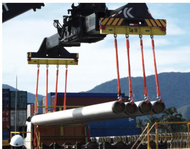
Estas lingas podem ser de sintéticas, de cabos de aço, de correntes ou mistas, conforme fotografia ao lado com lingas de 2 pernas (elevação vertical).
