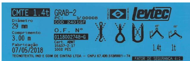
Modelos de etiqueta de cintas tipo GRAB de 1 e 2 pernas (lado esquerdo) e etiqueta de cinta com olhais padrão, tipo SLING (acima).
