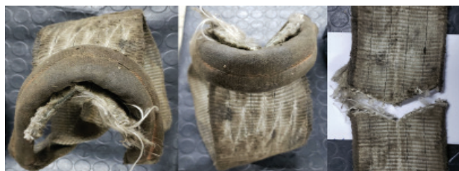
Cinta de 90mm de largura danificada em menos de 2 meses de uso
