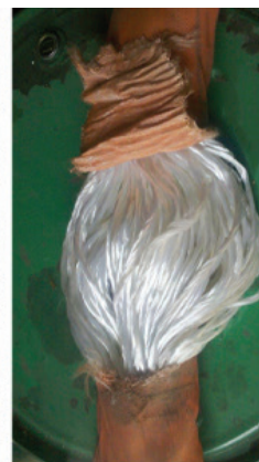
NÚCLEO EXPOSTO (sem danos)
