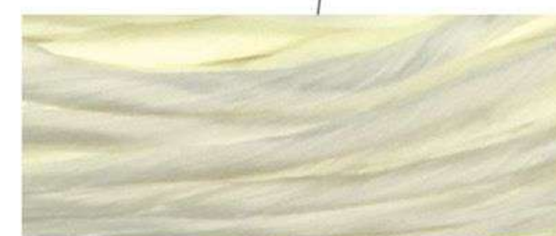
Núcleo em Dyneema® SK78 (HMPE)
