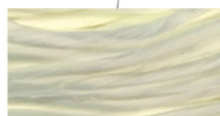
Núcleo em Dyneema® SK78 (HMPE)
