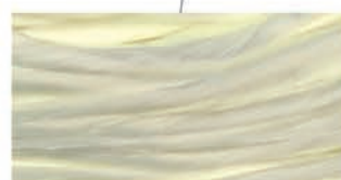
Núcleo em Dyneema® SK78 (HMPE)
