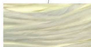
Núcleo de Dyneema® SK78 (HMPE)
